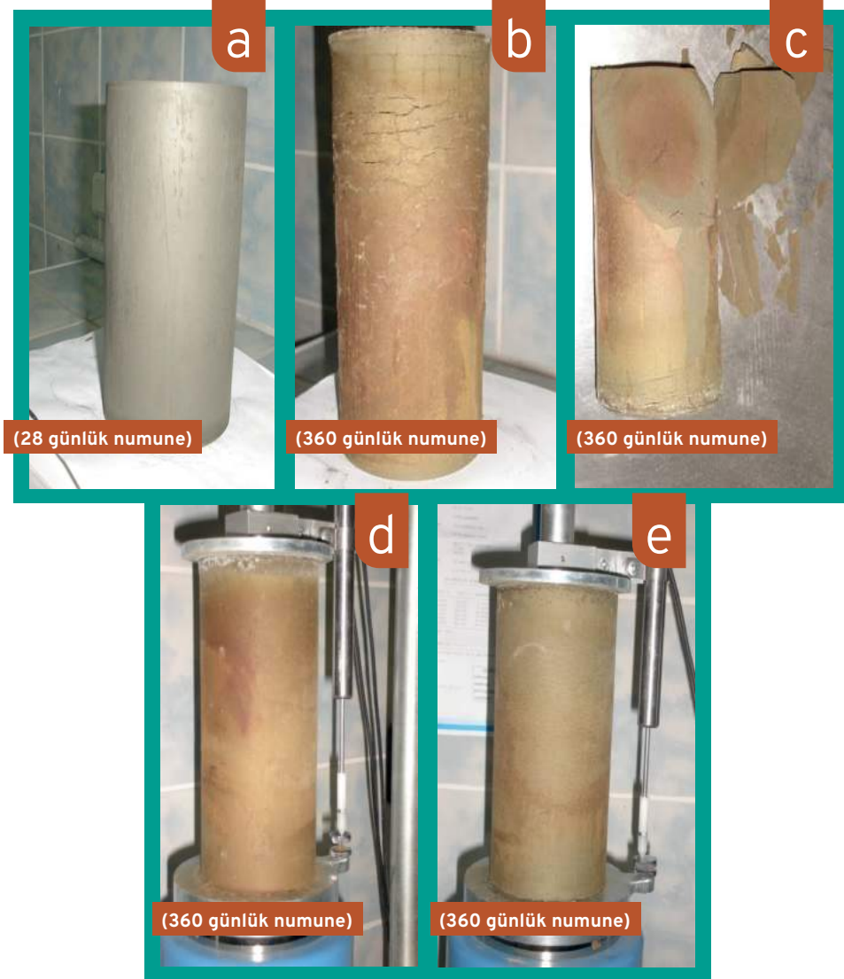
Şekil 9. Macun dolgunun 28 günlük kür süresi sonunda görünümü (a), dizaynı iyi yapılmamış numunede çatlamların oluşması (b) ve oksidasyonun numunenin içerisine ilerlemesi (c), dizaynı iyi yapılmış 360 günlük numuneler (d, e) (Erçikdi, 2009)
