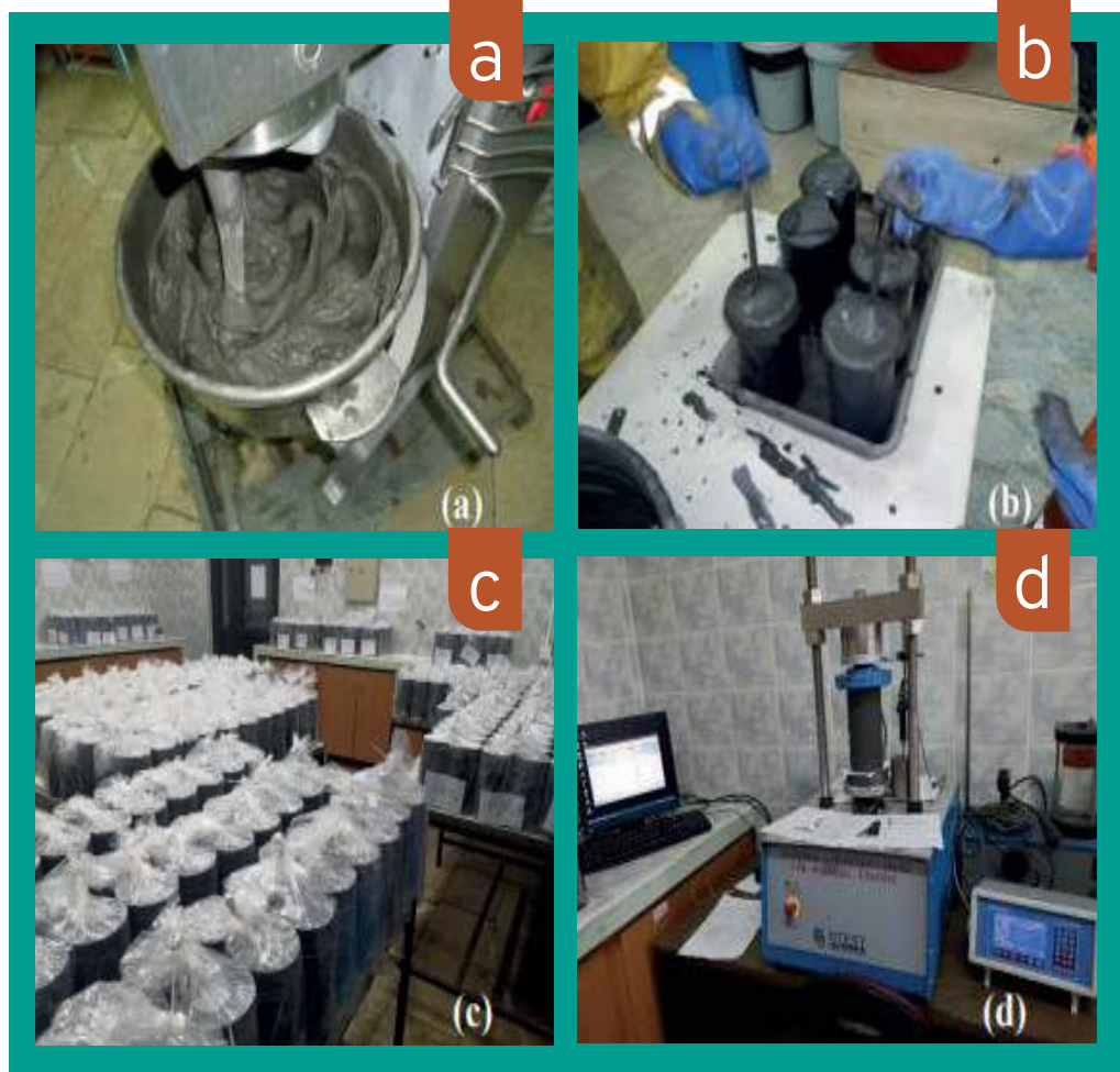
Şekil 7. Macun dolgu numunelerinin laboratuvar koşullarında hazırlanması ve testi: karıştırma (a); sıkılama (b); kür alma (c) ve UCS testi (d)
