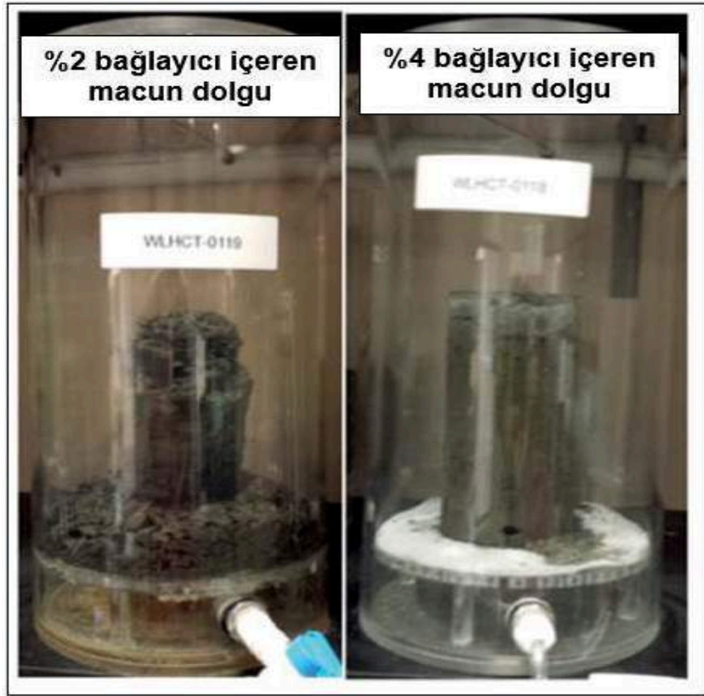
Şekil 12. Standart nem hücreli kinetik teste tabi tutulan %2 ve %4 bağlayıcı içeren macun dolgu numunelerinin 11 hafta sonundaki ayrışma/parçalanma görünümleri (Seipel vd., 2017)
