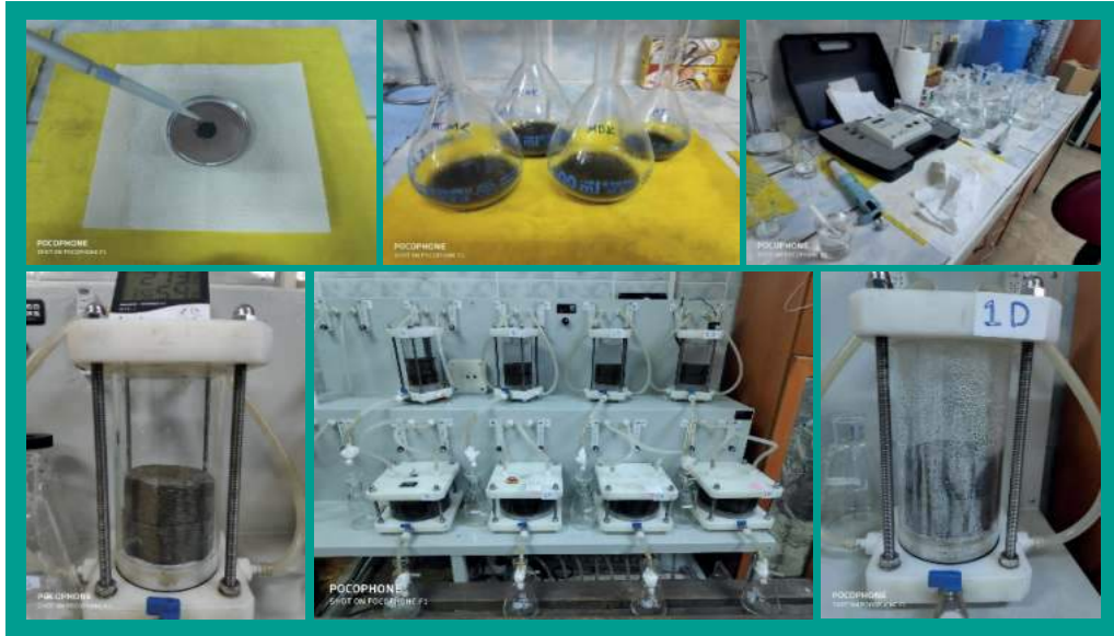
Şekil 11. Macun dolgunun su kalitesine etkisini araştırmak için yapılan statik ve kinetik testler (Erçikdi vd., 2021)
