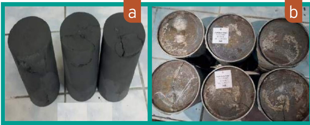
Şekil 8. Kil içeriği yüksek olan macun dolu numunelerinde nem içeriğinin yüksek olması nedeniyle 28 (a) ve 360 (b) günlük kür sürelerinde numunelerde oluşan çatlaklar
